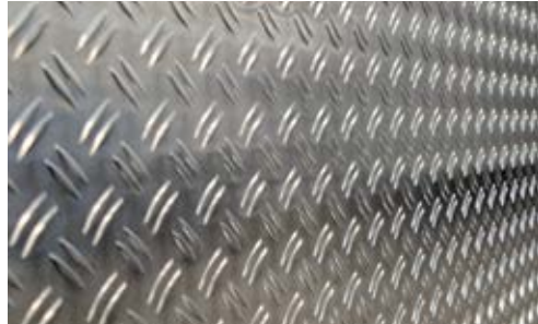
Bodenplatte mit Aluriffelblech belegt
