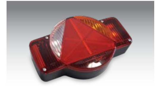
Rückfahrcheinwerfer (nur mit 13-poligem Stecker möglich)
