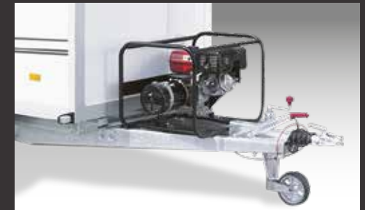
Stromerzeuger auf Deichsel
