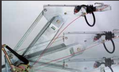
Höhenverstellbare Zugdeichsel (Kugelkopfkupplung und DIN Zugöse nicht inklusive)
